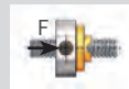
Dirección de carga principal Elija la dirección de carga principal, de modo que la carga descansa sobre la tuerca.
