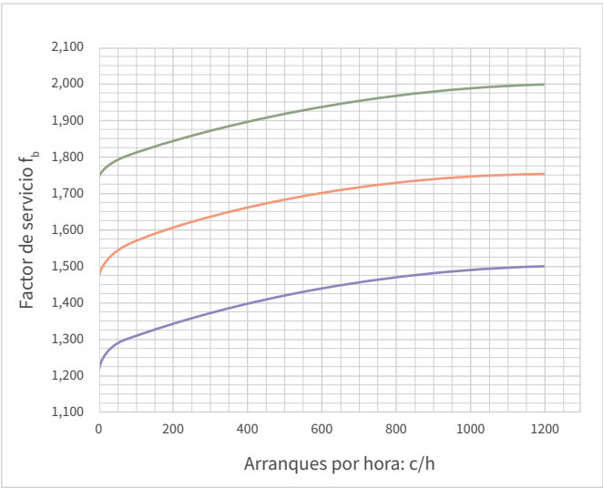
Determinación del factor de servicio f_b para 24 h/d de funcionamiento
