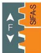
El tornillo sinfin soporta la carga a través del husillo. En caso de rotura de la rosca en el tornillo sinfin debido al desgaste, la SIFA atrapa el husillo y sostiene la carga.
