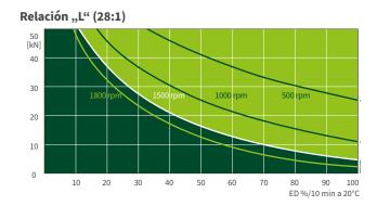
Este diagrama característico sirve de orientación bajo condiciones industriales estándar (temperatura ambiente 20 °C, etc.) y mantenimiento correcto (lubricación, etc.). Los mapas se basan en los husillos trapezoidales estándar ZIMM Tr 40x7. En los husillos de bolas KGT, los períodos de funcionamiento pueden ser mayores. Si necesita un período de funcionamiento o rendimiento aún mayor, encontrará información sobre nuestros elevadores de alto rendimiento ZE-H en las páginas 70 y 71.
