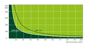
Este diagrama característico sirve de orientación bajo condiciones industriales estándar (temperatura ambiente 20 °C, etc.) y mantenimiento correcto (lubricación, etc.). Los mapas se basan en los husillos trapezoidales estándar ZIMM Tr 120x16. En los husillos de bolas KGT, los períodos de funcionamiento pueden ser mayores.
