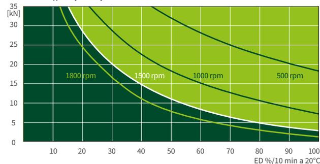
Este diagrama característico sirve de orientación bajo condiciones industriales estándar (temperatura ambiente 20 °C, etc.) y mantenimiento correcto (lubricación, etc.). Los mapas se basan en los husillos trapecoidales estándar ZIMM Tr 40x7. En los husillos de bolas KGT, los períodos de funcionamiento pueden ser mayores. Si necesita un período de funcionamiento o rendimiento aún mayor, encontrará información sobre nuestros elevadores de alto rendimiento ZE-H en las páginas 70 y 71.
