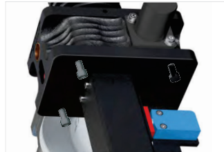
Rosca de agujero ciego (ZE- y GSZ-Serie): Los elevadores se pueden sujetar desde la parte inferior por medio de la rosca de agujero ciego. ZE Tamaño 5 hasta 25, GSZ-Serie: todos los tamaños
