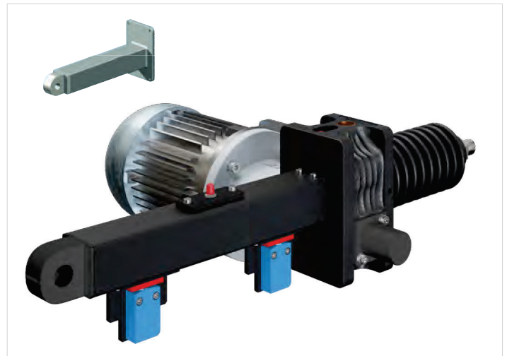
El tubo de apoyo basculante STRO tiene la ventaja de que los puntos de giro están en el exterior. La desventaja es que el peso del elevador y del motor está en el centro. La fabricación se realiza siempre de acuerdo con las especificaciones del cliente.
