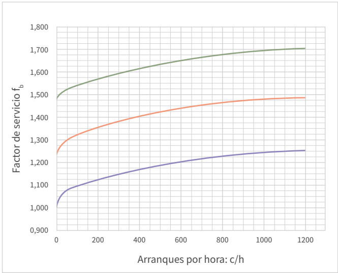
Determinación del factor de servicio f b para 16 h/d de funcionamiento
